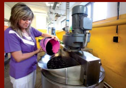
Směs pro slatinné zábaly se připravuje ve dvou speciálních bubnech. Po namíchání směsi se v přepravních nádobách výtahem dopraví do místnosti aplikace.
