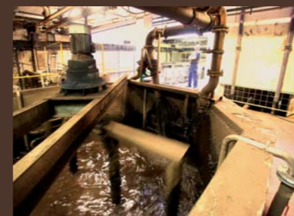
V obrovských mísicích nádobách se peloid míchá na správnou hustotu a zahřívá na požadovanou teplotu. Poté se dopravuje potrubím přímo do van pro slatinnou koupel.
