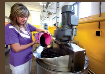
Směs pro slatinné zábaly se připravuje ve dvou speciálních bubnech. Po namíchání směsi se přepravními nádobami výtahem dopraví do místnosti aplikace.
